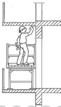
Fig. 9: Andamio situado en voladizo
