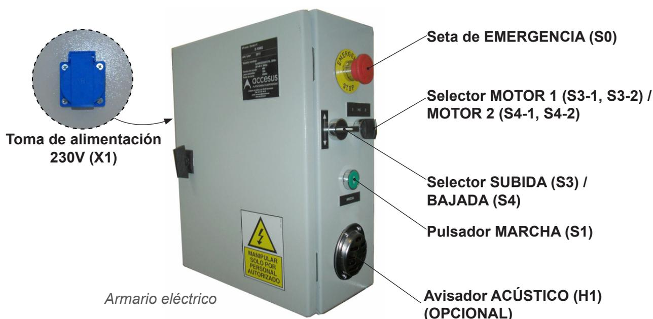
En caso de emergencia se puede detener el movimiento de la plataforma inmediatamente pulsando la "seta de emergencia" (S0) del armario eléctrico. Una vez desaparecida o eliminada la causa de la emergencia, girar el pulsador en el sentido que indican las flechas, pulsar el botón VERDE de marcha (S1). Finalmente usar el selector de SUBIDA (S3) o BAJADA (S4).
