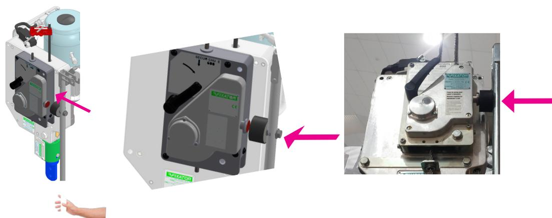
Activación del anticaidas para PARADA DE EMERGENCIA con la barra de accionamiento múltiple (10)
