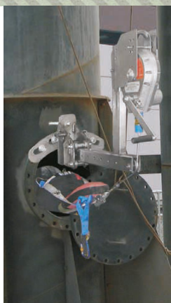
Brazo de rescate MW para boca de hombre con ARR.
