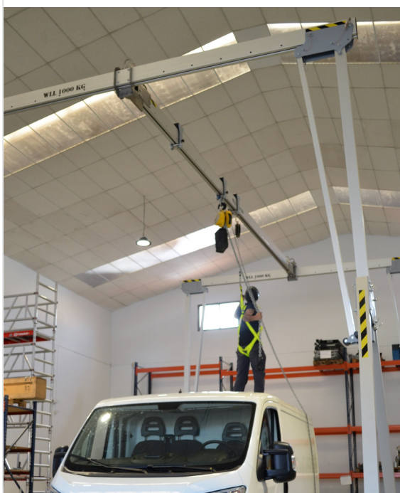
Ejemplo de montaje de pórtico BAS.
