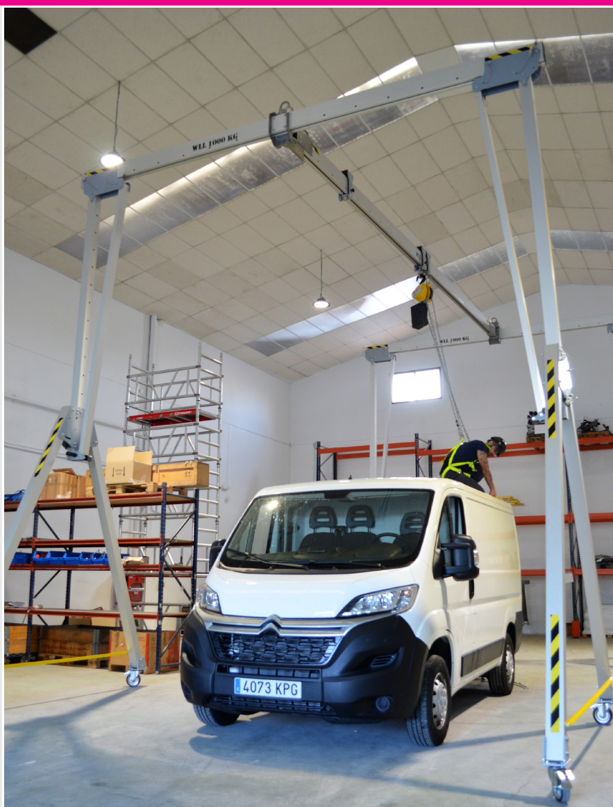
Montaje del pórtico BAS en su configuración en forma de H.
