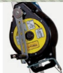
ANRW 300 conectado en la cabeza o la pata del trípode con el adaptador TRI 172
