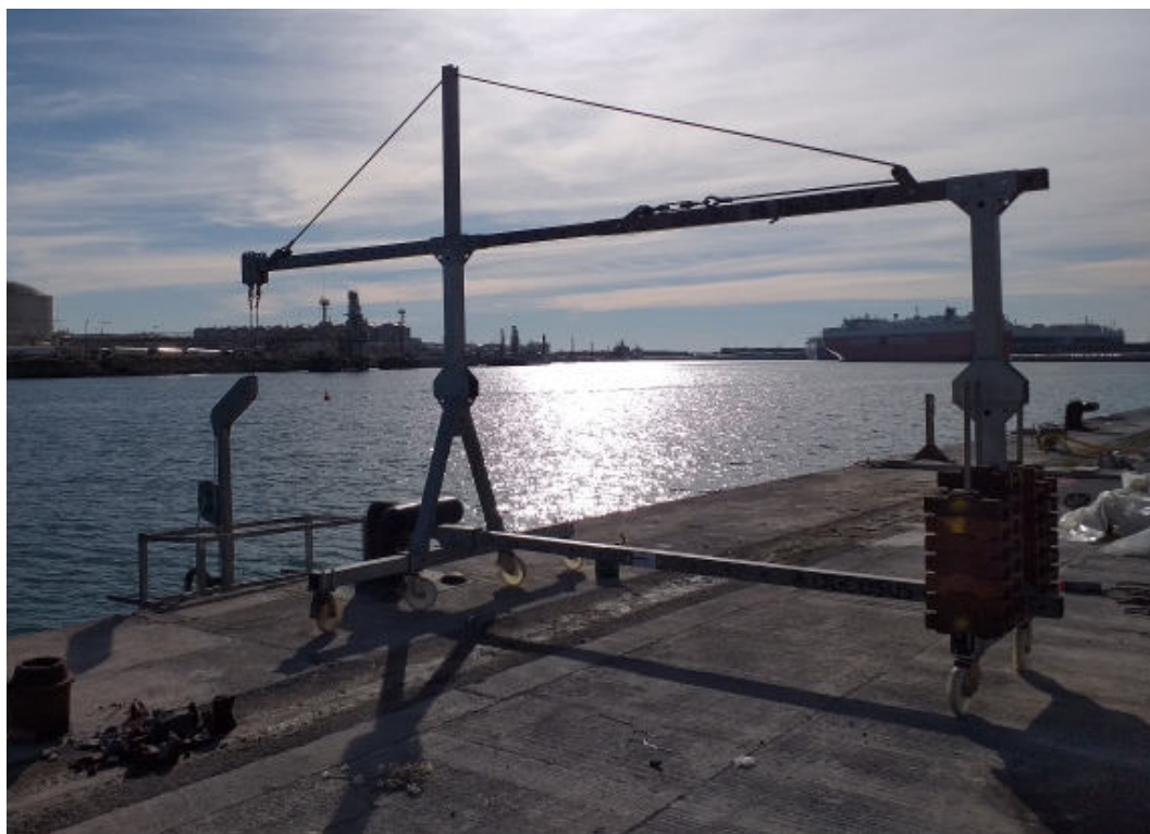
Configuration du bossoir BRAKOO modèle 3B avec une hauteur de 2,2 metros et cantilever de 2 mètre avec une cabine Basic.
