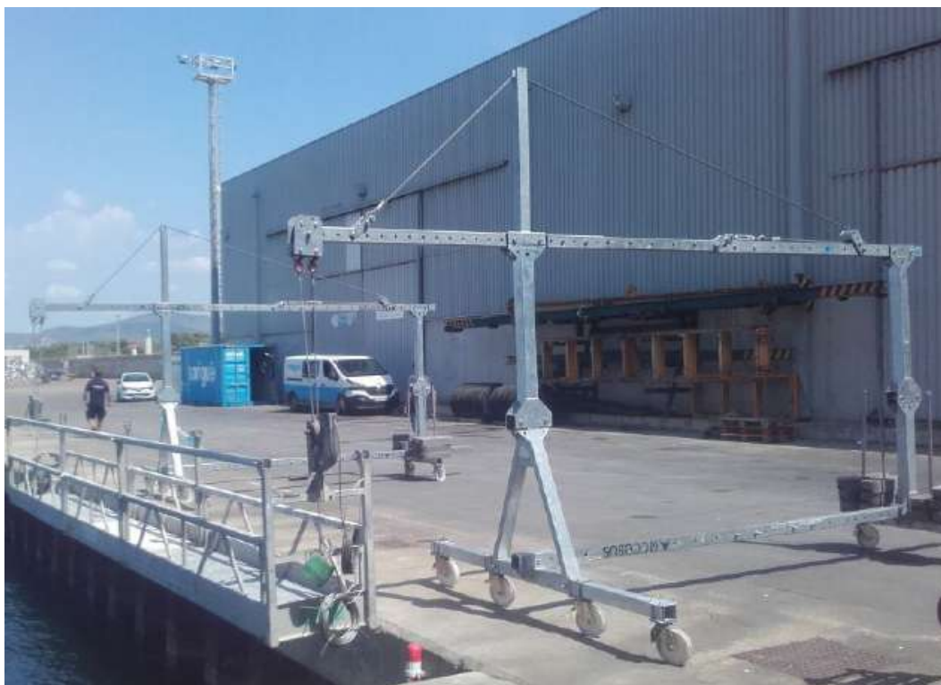
Configuration du bossoir BRAKOO modèle 3B avec hauteur de 2,2 mètres et vol de 2 mètres avec plate-forme Komplet manuelle.
