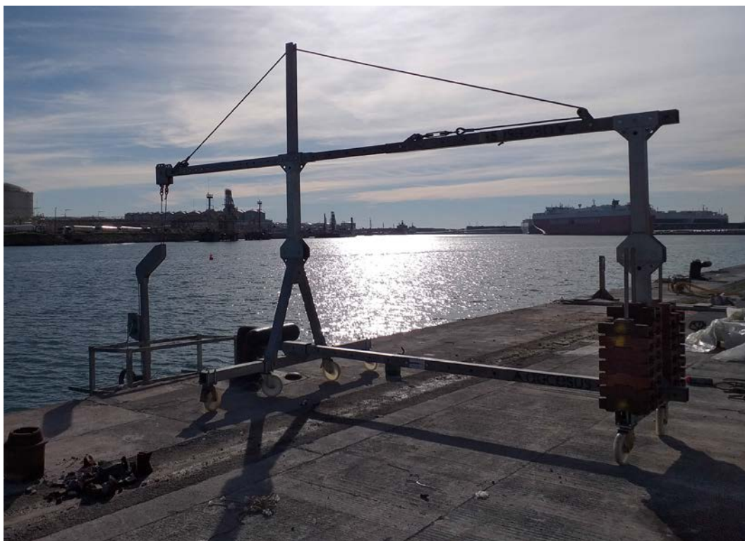
Configuración de pescante BRAKOO modelo 3B con altura de 2,2 metros y vuelo de 2 metros con cabina Basic.
