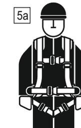
6a El cinto para mantener la posición de trabajo debe encontrarse a la altura de la cintura. Las hebillas deben estar puestas simétricamente por ambos lados.
