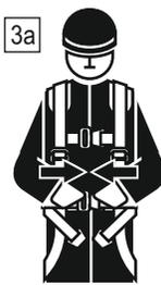
3a Cierre la hebilla y ajuste la cinta del cinturón para mantener la posición de trabajo.
