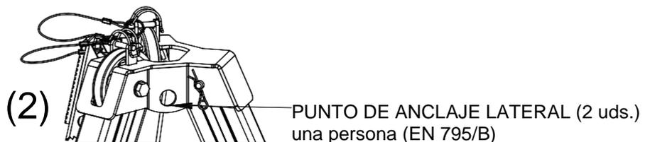
TRI14 EMPLEADO COMO SISTEMA DE EVACUACIÓN MULTIFUNCIONAL (SEM) tiene tres puntos de anclaje empleados para la protección de personas:
