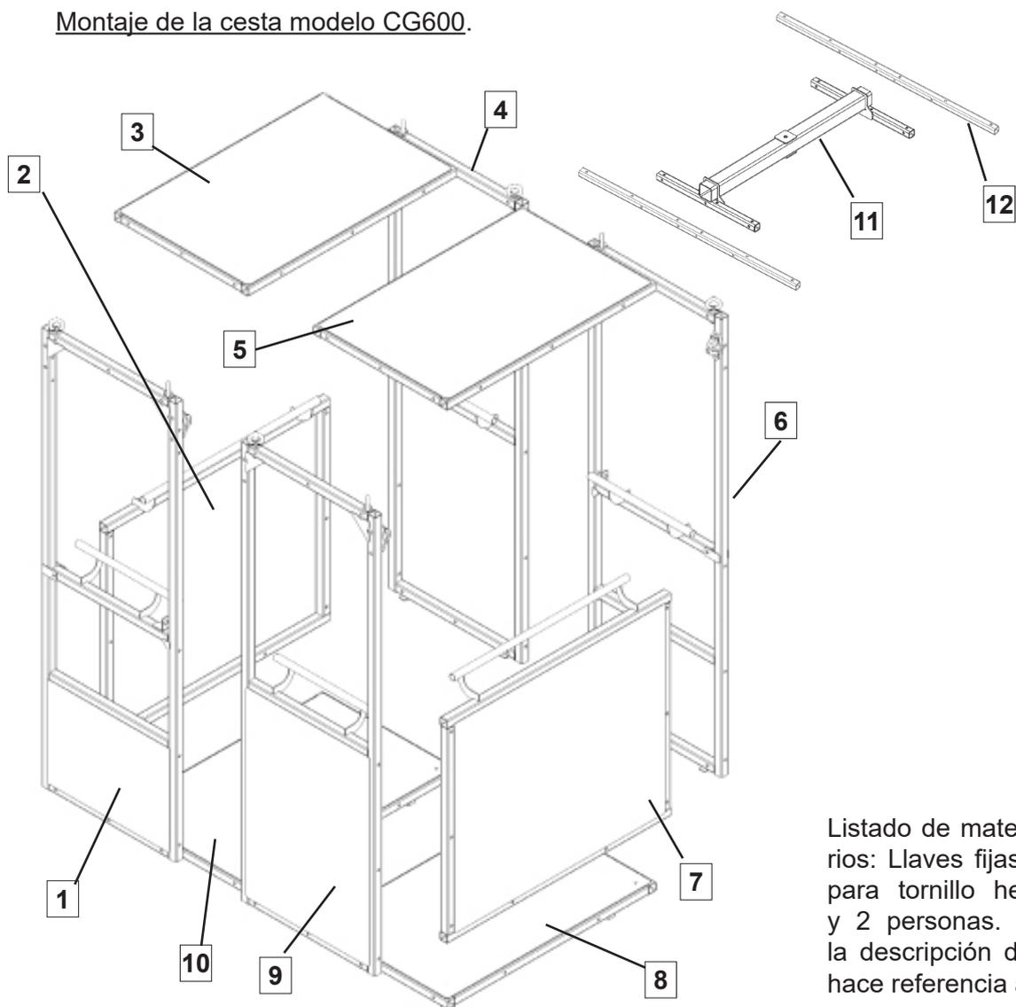
Listado de materiales necesarios: Llaves fijas y de carraca para tornillo hexagonal M10 y 2 personas. Tornillería (en la descripción del montaje se hace referencia a esta lista)
