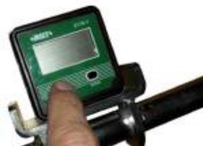
Antes de comenzar los trabajos, realizar una comprobación de medición de ángulo con la plataforma suspendida a 1m de altura. La lectura de la pantalla del inclinómetro debe ser 90° o muy cercano. Ver siguiente imagen.
