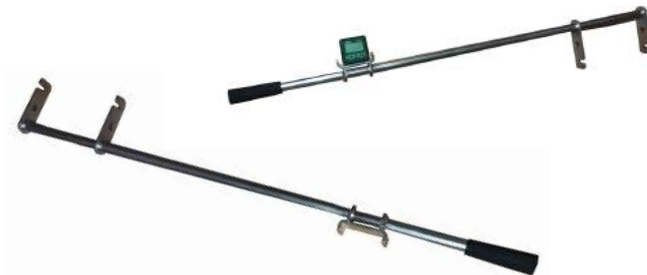
La medición del ángulo (A) se realiza posicionando las ranuras del útil en el cable de trabajo o seguridad según las siguientes imágenes.
