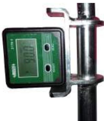
El ángulo (A) que debe indicar el inclinómetro debe estar en un rango entre 76° y 90°.
