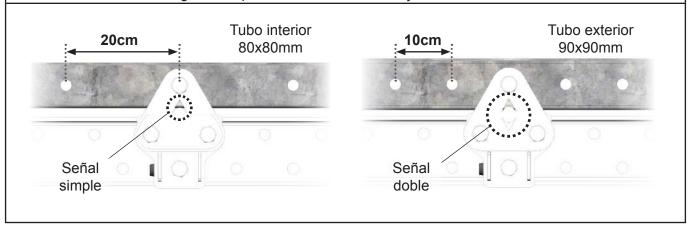
4-Posicionar los 4 anclajes (pos. II.4) con 1 tornillo T2+T3 sobre cada fijación, colocándolos a través del taladro exterior. NO apretar todavía.
