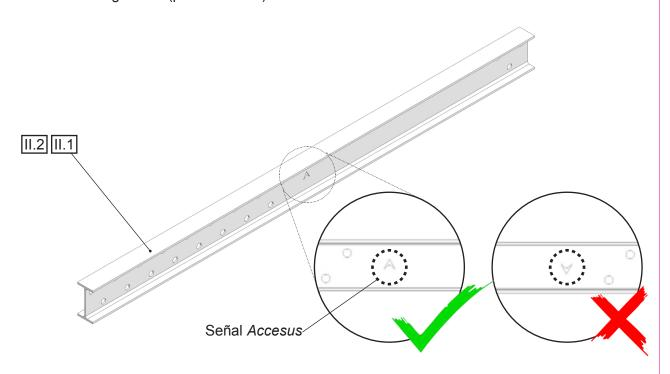
2-Colocar 2 fijaciones (pos. II.3) en el extremo de la viga "fijo" (el extremo que dispone de solo 3 taladros) y fijar mediante 1 tornillo T1+T3. Apretar hasta que las fijaciones presionen el alma de la viga. Asegurarse de que los topes de goma están en la posición correcta en ambas fijaciones.
