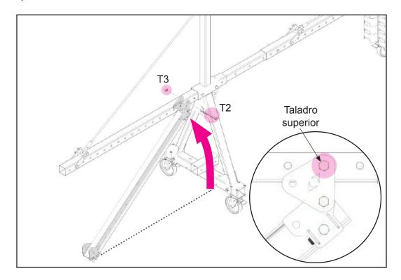
6-Levantar el extremo opuesto de la viga carril y fijarlo mediante 1 tornillo T2+T3 a través del taladro superior del anclaje y el taladro coincidente del pescante BRAKOO.
