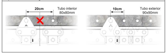
3-Colocar las otras 2 fijaciones (pos. II.3) a la distancia deseada y fijar mediante 1 tornillo T1+T3. Apretar hasta que las fijaciones presionen el alma de la viga.
