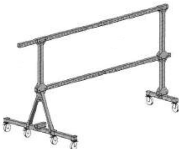
12-Bloquez les freins des roues (point 13) sur les deux bases (point 4). Placez du bois, des planches ou des profils métalliques sur les roues avant et arrière (point 13) pour protéger la couverture du toit, pour répartir les charges et pour faciliter le mouvement.
