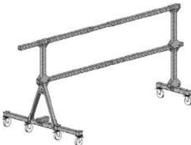
12-Bloquer les freins des roues (point 13) sur les deux bases (point 4). Placez du bois, des planches ou des profils métalliques sur les roues avant et arrière (point 13) pour protéger la couverture du toit, pour répartir les charges et pour faciliter le mouvement.
