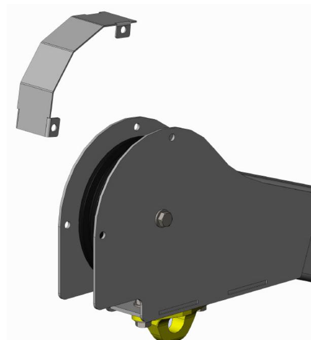
Tendremos que accionar el motor para ir desenrollando el cable y pasarlo por las poleas, una vez realizada esta operación volveremos a montar las protecciones.
