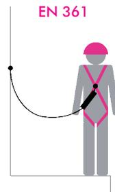
O arnês A03S está em conformidade com a norma EN 361 para dispositivos de paragem de queda (ponta de ancoragem dianteira e dorsal).
