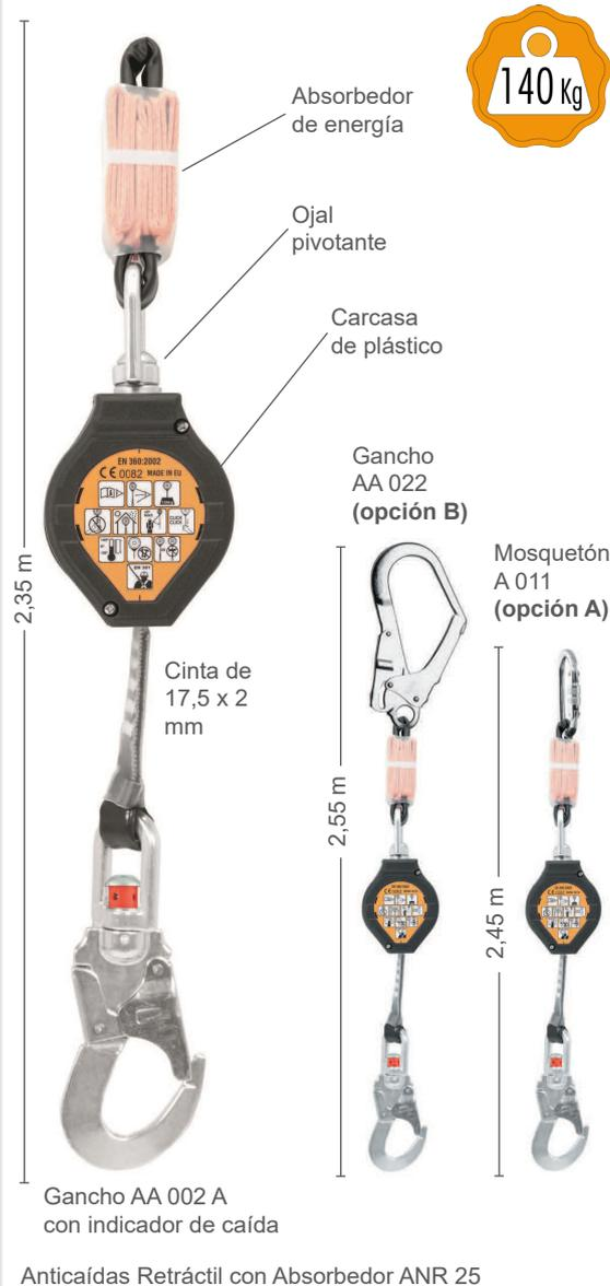
Anticaídas Retráctil con Absorbedor ANR 25 para uso horizontal con eslinga 610500
