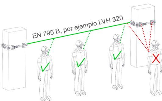
Modos de utilización correctos e incorrectos del punto de anclaje de columna LVH 100 y la línea de vida temporal horizontal LVH 320.
