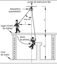
tirando dinámicamente el cable de trabajo. El cable debe bloquearse y después de soltar, se debe enrollar libremente (ser retirado por el dispositivo). La persona que utiliza el dispositivo realiza a inspección y verificación.
