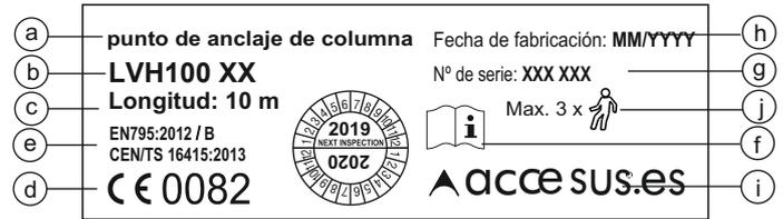
Figura 4 Marcación del dispositivo
