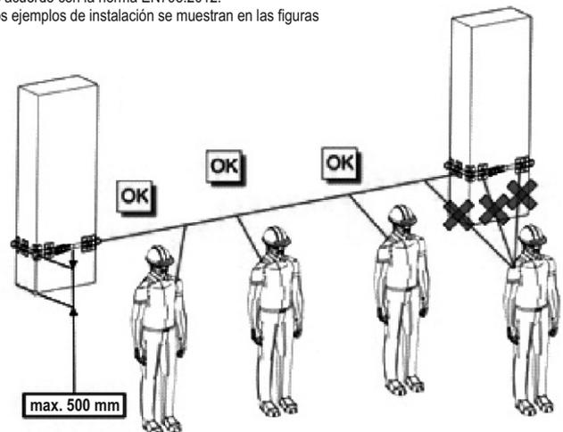
Figura 6. Uso de sistemas de anclaje horizontal
