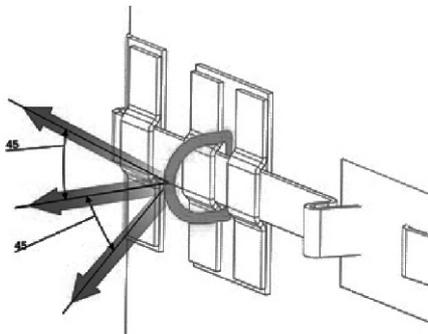
Figura 3 Direcciones permitidas de carga del punto
