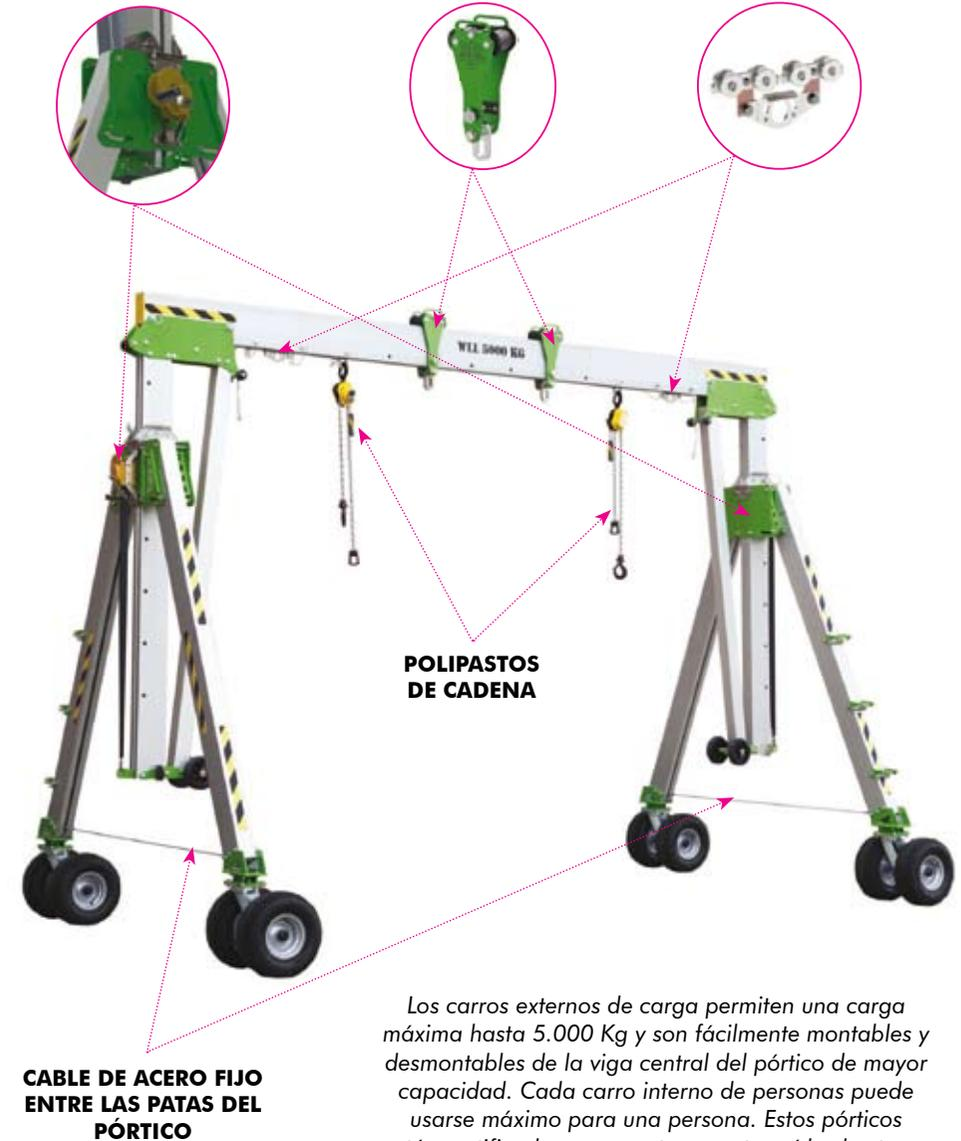
Los carros externos de carga permiten una carga máxima hasta 5.000 Kg y son fácilmente montables y desmontables de la viga central del pórtico de mayor capacidad. Cada carro interno de personas puede usarse máximo para una persona. Estos pórticos están certificados para proteger ante caídas hasta un máximo de 5 personas.
