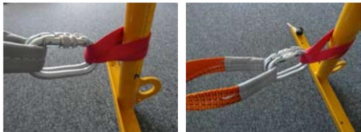
\*Para el punto de anclaje PAT 900 hay que ponerlo doble tal y como se muestra en las fotografías.
