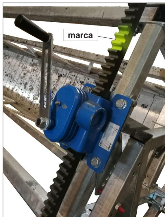
Mediante las manivelas de las cremallera, se ajusta el ángulo. Es importante realizar esta operación con las dos manivelas a la vez, para ir reduciendo o aumentando el ángulo de ambas liras a la vez y en la misma sentido de apertura o cierre del ángulo.
