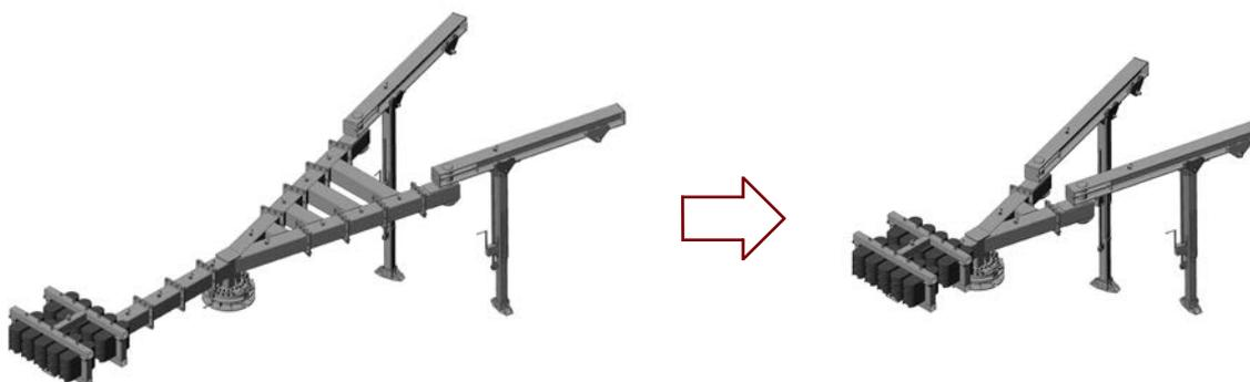
Para proceder a esta modificación de las configuraciones, se instalará la estructura en una base especialmente diseñada para tal uso. Se anclará la base de la suspensión (6) a esta base con 12 tornillos T10.
