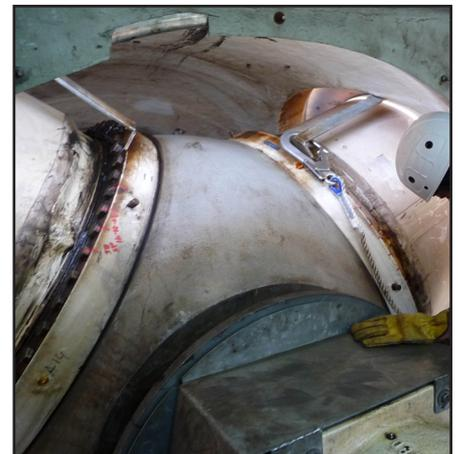
2- Abrazamos el eje principal del rotor en el interior de la nacelle mediante una eslinga metálica de suspensión 200028 de 3m de longitud, unimos los dos extremos de la eslinga mediante un grillete de 1.8T de capacidad con tuerca y pasador.
