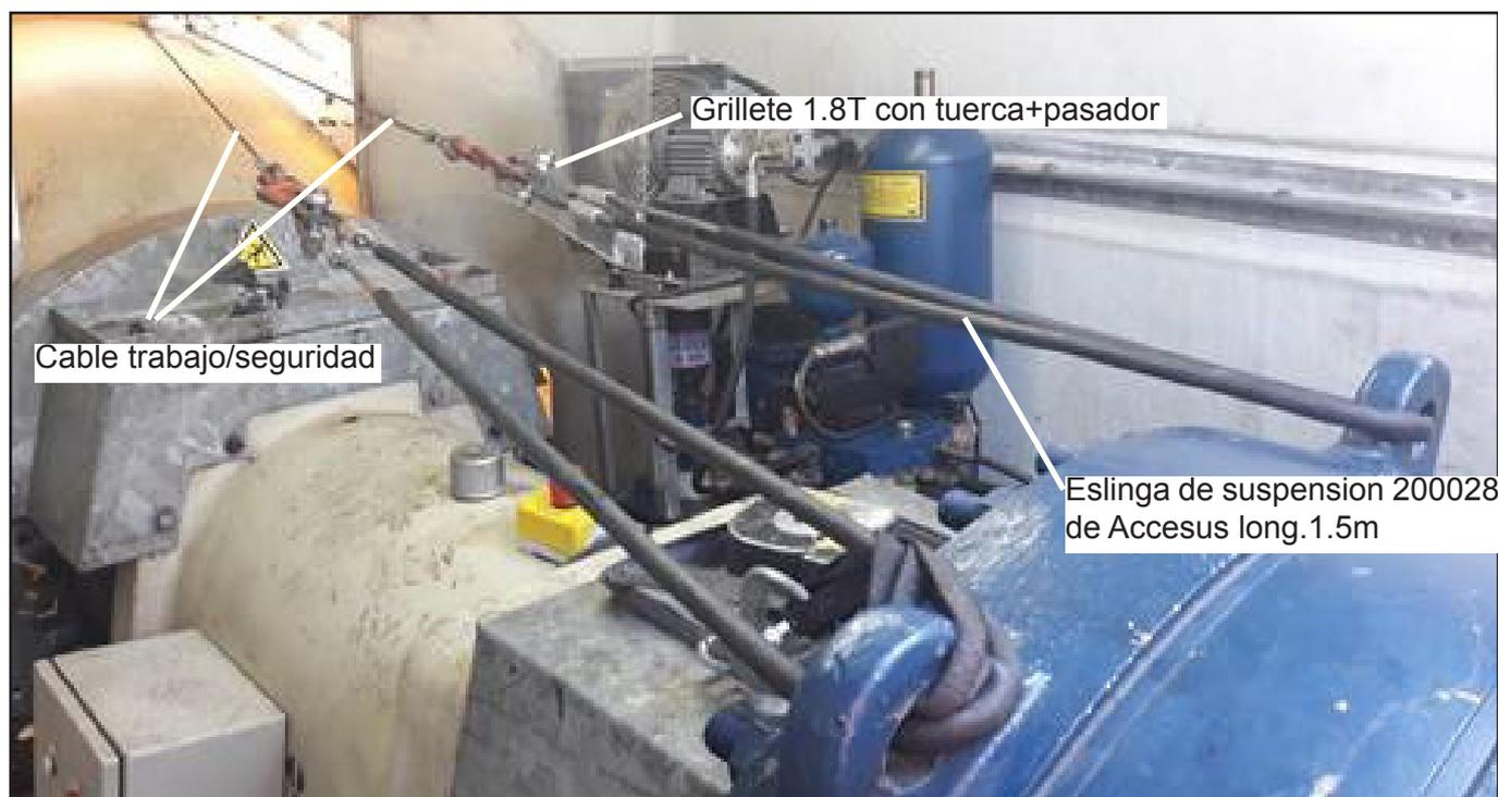
3-Preparamos el anticaídas de cable anclado mediante la eslinga textil de longitud suficiente y un grillete a un punto suficientemente resistente para soportar el peso del cable (0.25kg/m), como uno de los puntos de izado del caballete.
