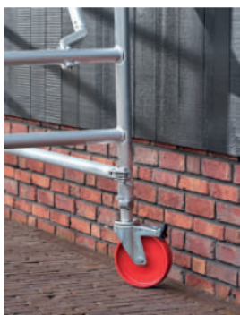
Ruedas con doble freno (Ø 200 mm), 18 cm con husillo.
