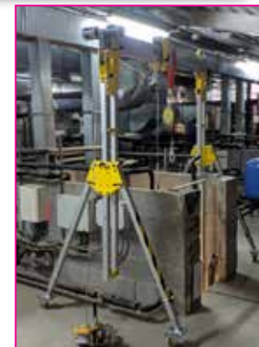
Elevación de cargas y personas en espacio confinado.
