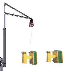
Percha con anclaje método 4. Punto de anclaje temporal tipo davit para fijación en estructuras de acero. Suspensión de andamios colgantes. Incluye mástil, brazo y sistema de fijación para estructuras de acero con placa y contraplaca pequeñas (40 x 25 cm) y grandes (40 x 40 cm).
