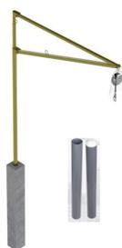
Percha con anclaje método B. Punto de anclaje temporal tipo davit para ser embebida en hormigón. Suspensión de andamios colgantes. Incluye mástil, brazo y sistema de fijación con casquillo plástico para forjado en hormigón. Consultar posibilidad de incluir eslinga de transporte de 2 m (PAT210-02B).
