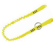
Porta herramientas elástico de cinta de poliéster para prevenir la caída de herramientas pesadas tipo motosierras. Ancho de cinta 25 mm. Longitud 1,3 m. Carga máxima 4 Kg.
