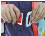
**1.** Asegúrese que las cintas no estén retorcidas. El cabo sobrante final es para el ajuste y debe queda siempre hacia el exterior (por fuera del usuario).
