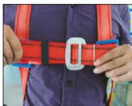
**3.** Tire del extremo sobrante de las cintas para ajustar el arnés. Deslice las hebillas hasta la posición correcta y pliegue y sujete los excesos de cinta con el retenedor elástico.
