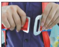
**1.** Asegúrese que las cintas no estén retorcidas. El cabo sobrante final es para el ajuste y debe quedar siempre hacia el exterior (por fuera del usuario).
