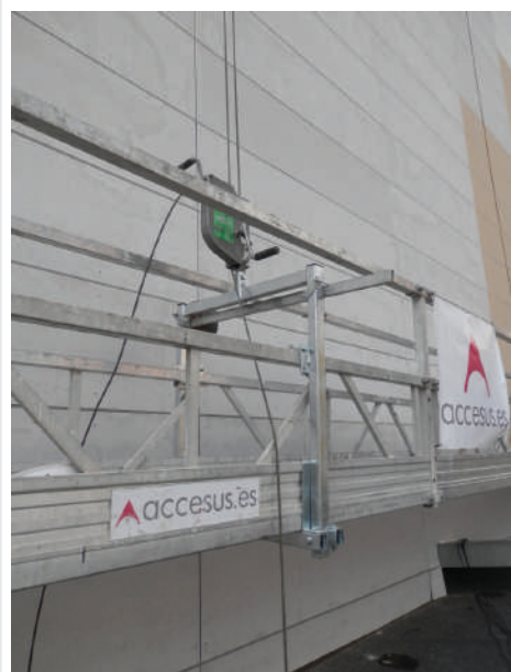
Lyres de passage Accessus 200036 montée sur une plateforme en aluminium de 12 m avec l'élevateur manuel m.lift
