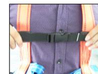
**3.** Puxe a extremidade excedentária das correias para ajustar o arnês. Deslize as fivelas para a posição correta e dobre e mantenha a fita em excesso com o retentor elástico.
