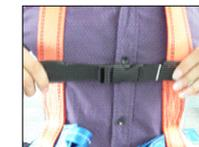
**3.** Tire del extremo sobrante de las cintas para ajustar el arnés. Deslice las hebillas hasta la posición correcta y pliegue y sujete los excesos de cinta con el retenedor elástico.
