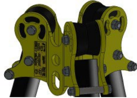
Figura 7 - Ubicación de marcado del equipo AT254
