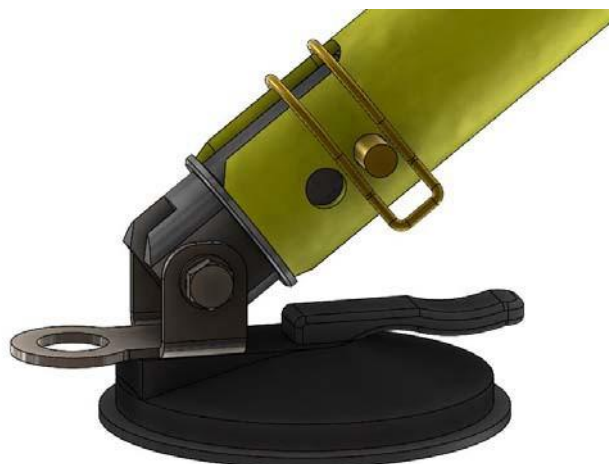
Figura 3. Pie extraíble con ventosa
