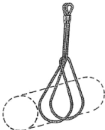
Evite trabalhar onde o sling, subsistema ou outros componentes do sistema entrem em contacto ou esfregue-os em pontas de corte desprotegidas. Não rodeie a amarração em elementos estruturais de pequeno diâmetro. Se trabalhar com este equipamento perto de arestas afiadas é inevitável, deve ser protegido contra o corte por estofos pesados ou outros meios colocados na extremidade de corte.
